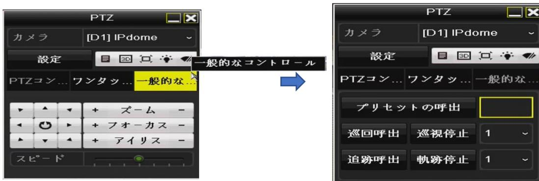
図 4.4 PTZ パネル - 一般的なコントロール
