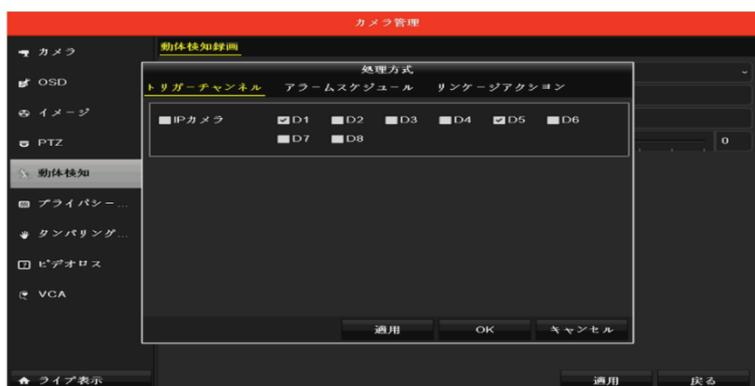
図 8.2 動体検知のカメラ起動の設定
