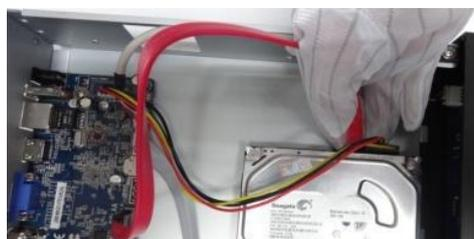
5 ハードディスクドライブは DVR 本体に 4 か所のネジで底面から固定します。
