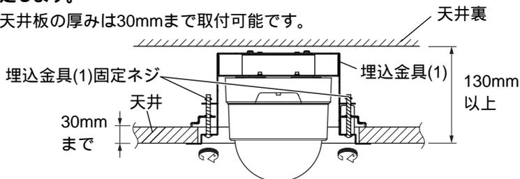
(6) 埋込金具(1)を天井に固定後化粧パネルをパネル取付リベット2個で取付けてください。
