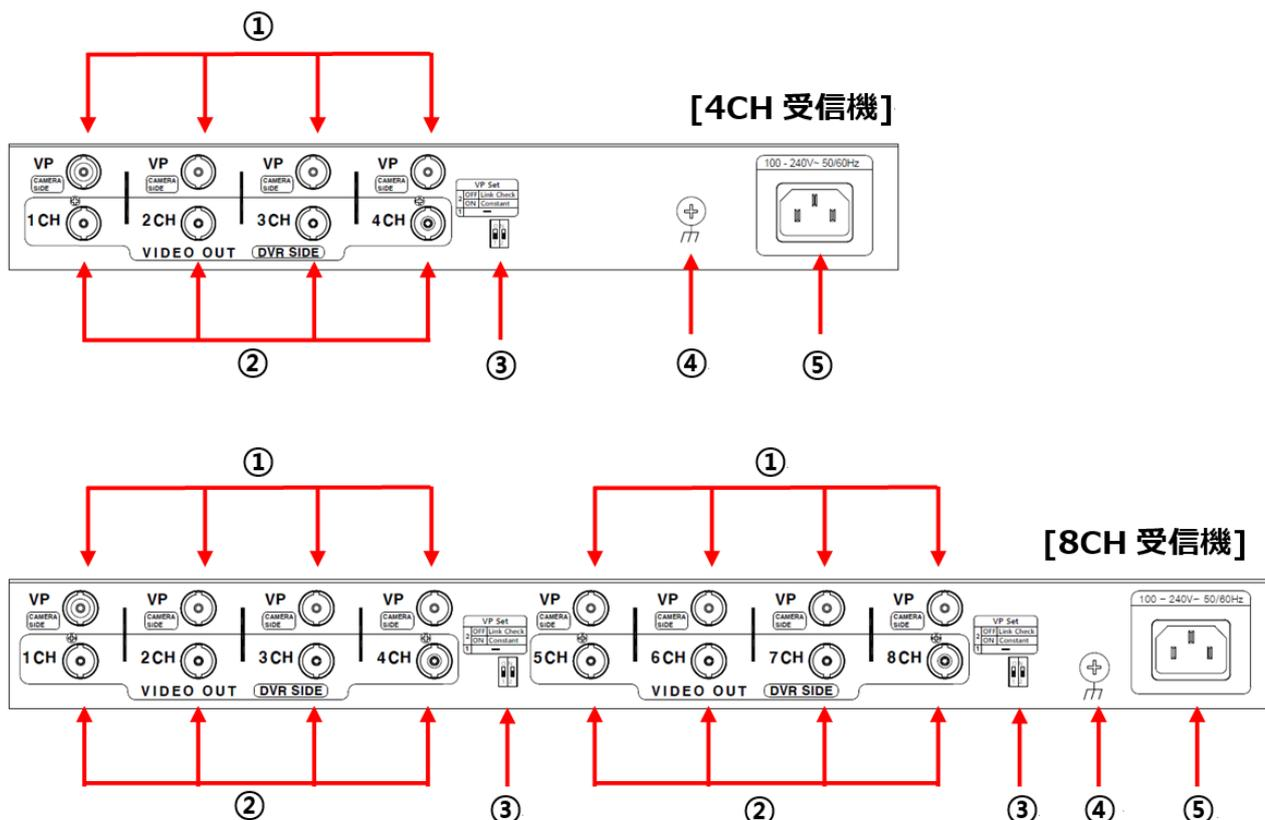
① ワンケーブル(VP)入力端子: ワンケーブルカメラ接続端子
